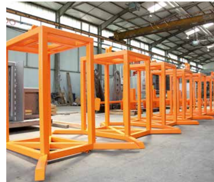
Ständer einer Vorrichtung für Betonfertigteilmontage
